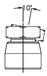
d1 = 24 d2 = M12 l1 = 25 l2 = 10 NV = 18 Static load (N) = 10000 t min = 12
